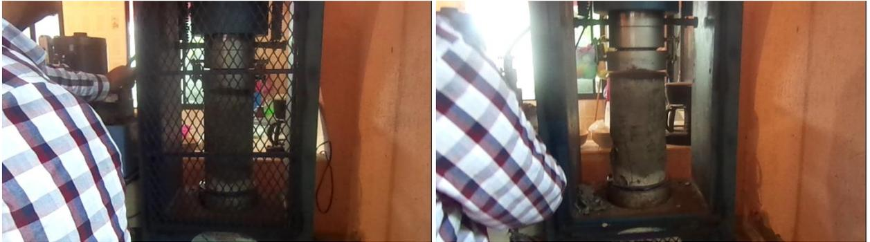
**Figura 29. Ensayo a la compresión de especímenes de concreto.**
