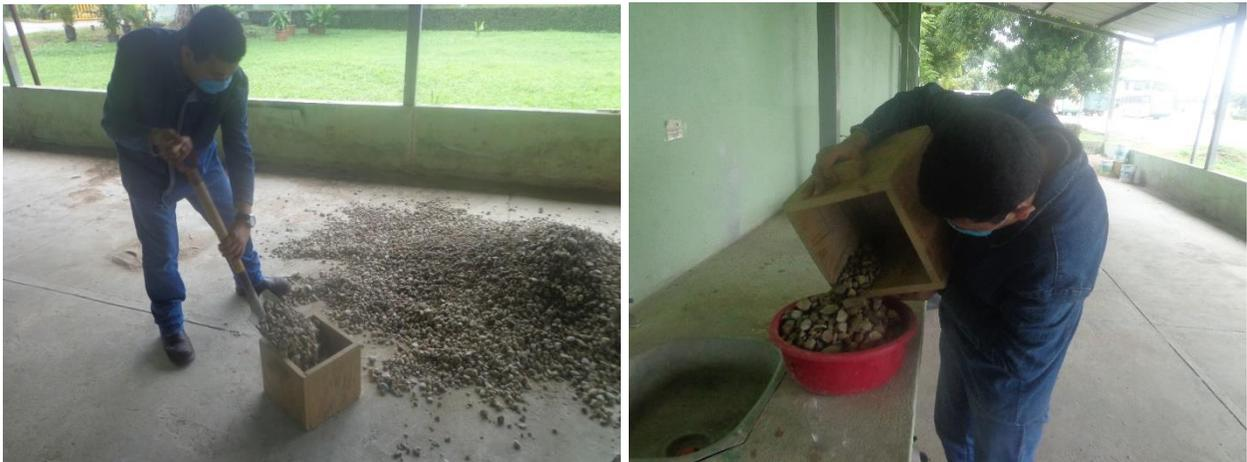
**Figura 7. Obtención del peso volumétrico seco de la grava.**
