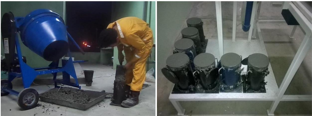
**Figura 25. Obtención de los especímenes de concreto.**
