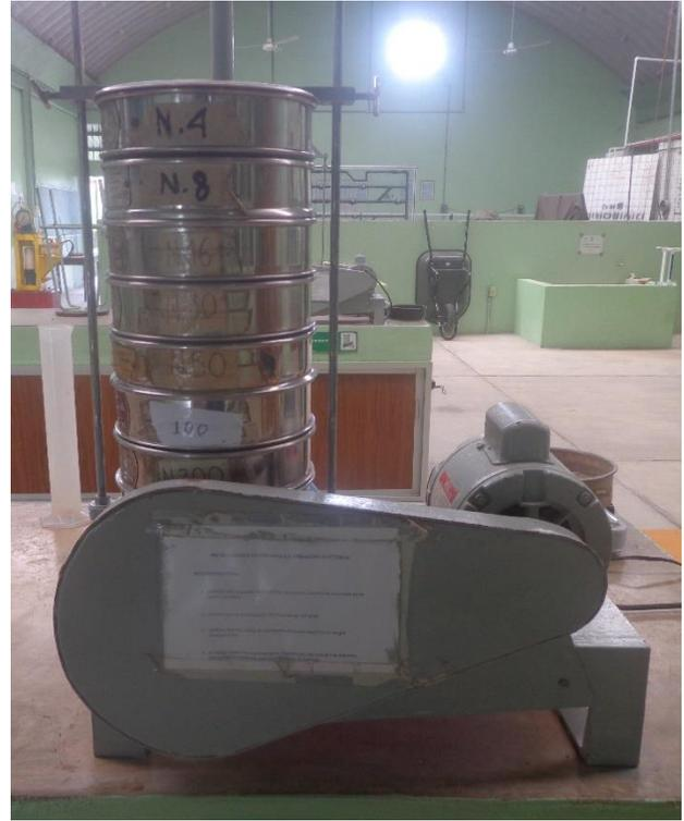
**Figura 13. Procedimiento de cribado de la arena.**
