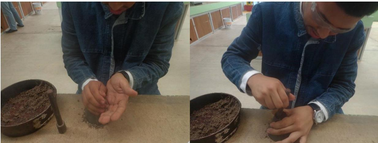
**Figura 11. Comprobación del estado saturado y superficialmente seco de la arena.**
