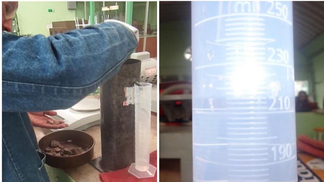
**Figura 8. Prueba para obtención de densidad relativa.**
