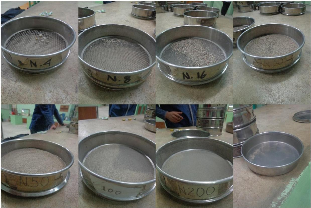
**Figura 14. Material retenido en cada malla de cribado de la arena.**
