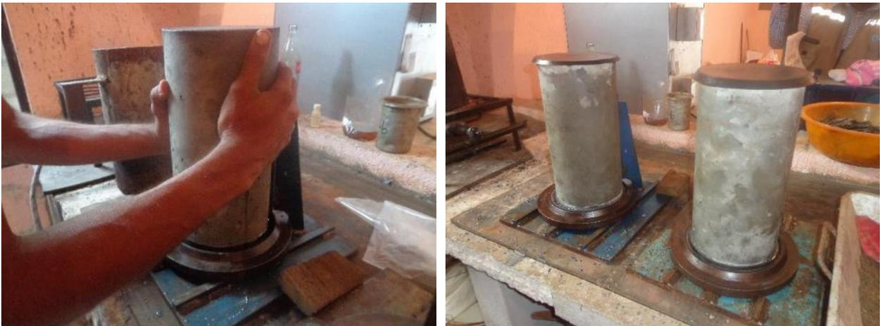
**Figura 28. Cabeceo de los especímenes de concreto.**
