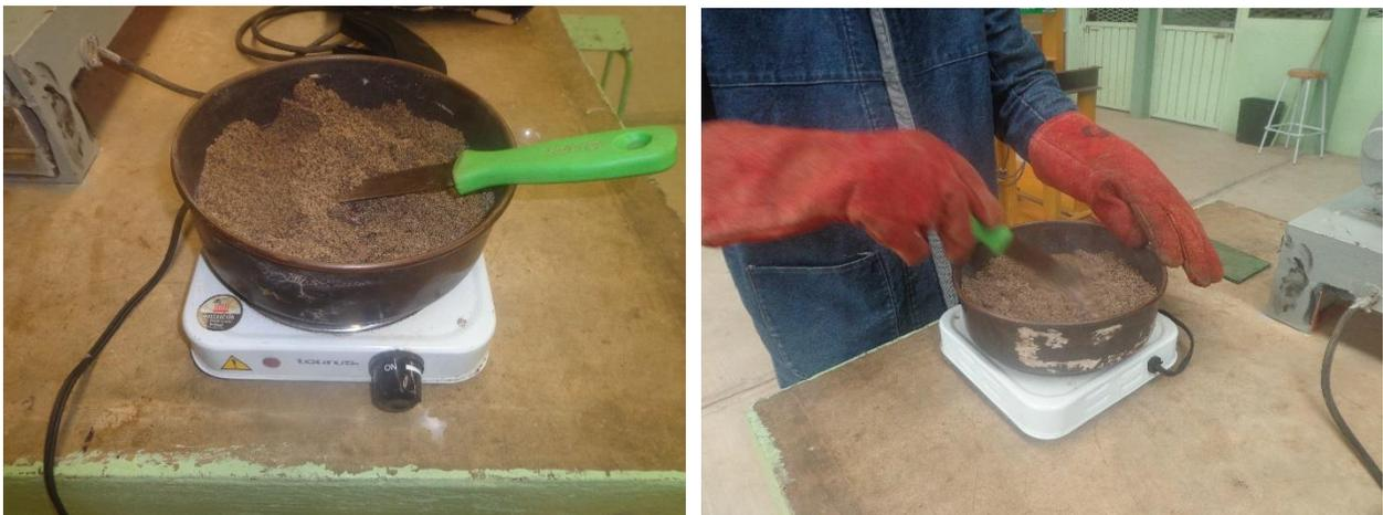
**Figura 20. Ensaye de humedad a los materiales de la mezcla.**
