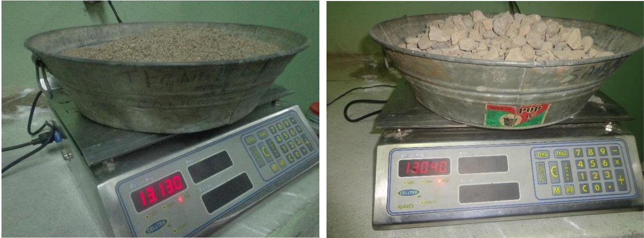
**Figura 19. Pesaje del material necesario para elaborar la mezcla.**
