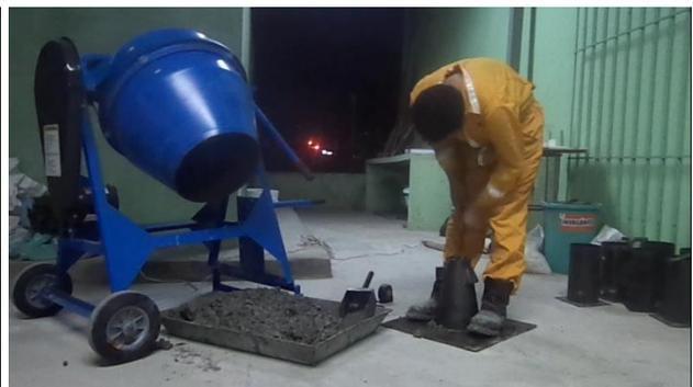
b) Varillado del concreto fresco
