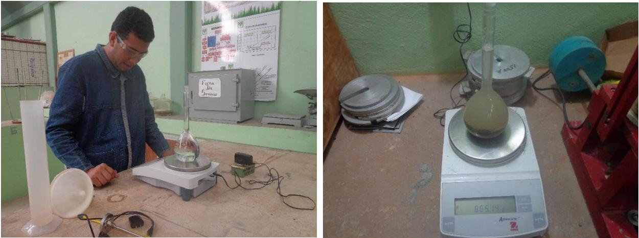
**Figura 12. Procedimiento para determinación del peso específico de la arena.**
