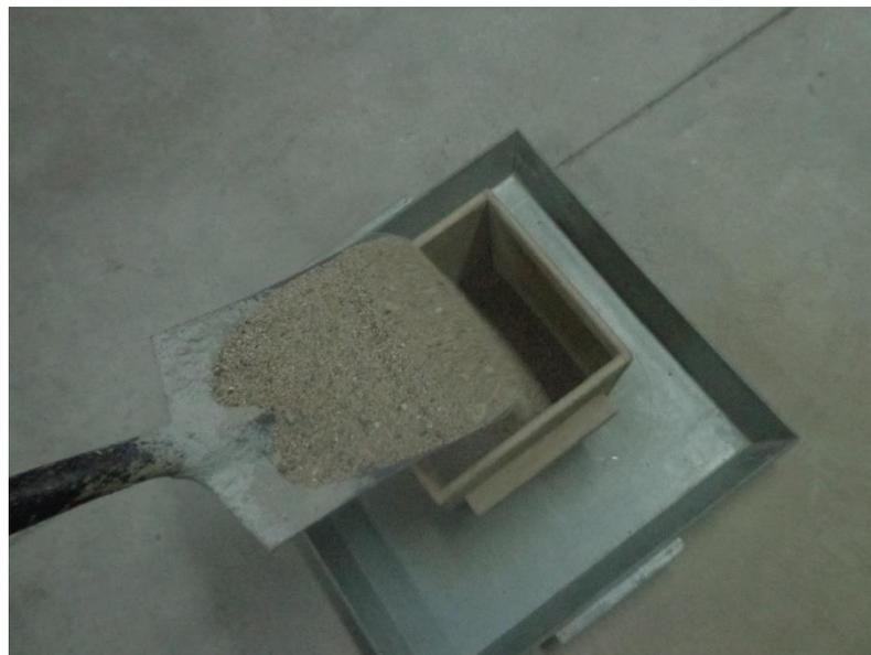
**Figura 10. Obtención del peso volumétrico de la arena.**
